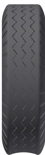
Falta de pressão
